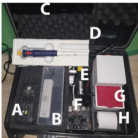
Рис. 1. Прототип ПАК Onsiteseq. Слева направо: (A) Кассета Flongle (B) Нанопоровый секвенатор “Нанопорус” (C) Сенсорный экран (D) Шприц-дозатор (E) Коммуникационный блок Wi-Fi/4G (F) CPU/GPU процессор на базе платформы Nvidia Jetson (G) Амплификатор (H) Термопринтер
